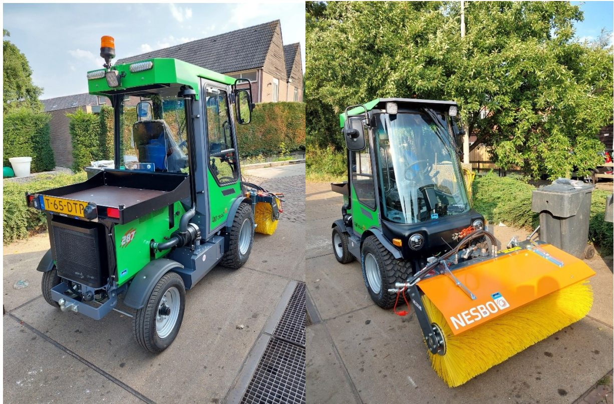
foto LM-track (met MMBS-kenteken) voor onkruidbestrijding met sneeuwborstel
